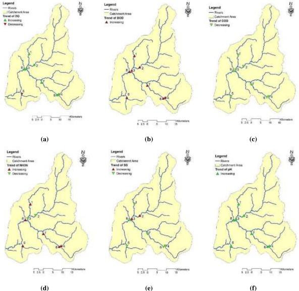
**Fig. 2.** Parameter trends for (a) DO, (b) BOD, (c) COD, (d) NH<sub>3</sub>-N, (e) SS and (f) pH
